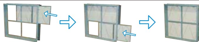
フィルタを入れる前に、連結器に予めヒッカケて連続して差し込みます。
